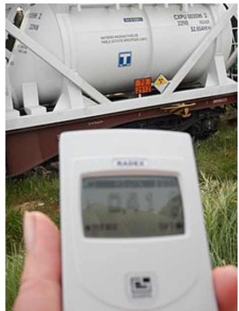
Mesure de radioactivité à proximité d'un train d' UF_4 sortant de Malvési
