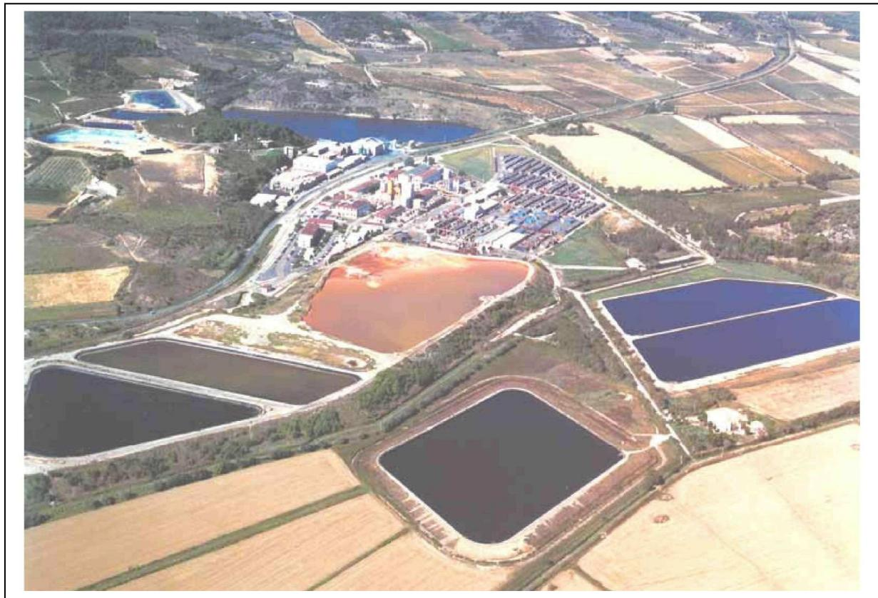
Photo aérienne montrant les bâtiments industriels, le stockage des fûts à l'air libre et les différents bassins de décantation et d'évaporation (au 1<sup>er</sup> plan, au centre, le bassin B9). Situation avant la construction des bassins B10 et B11. Photo présentée par la COMURHEX à la CLIC du 25/11/05.
